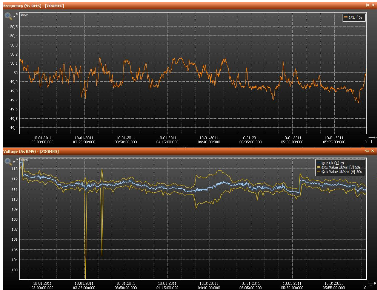
Bild 8: Recht unauffälliger Verlauf der Netzfrequenz (oben) bei auffälligen Kurzzeiteinbrüchen und deutlichen Abweichungen der Spannung an der Messstelle (unten)
