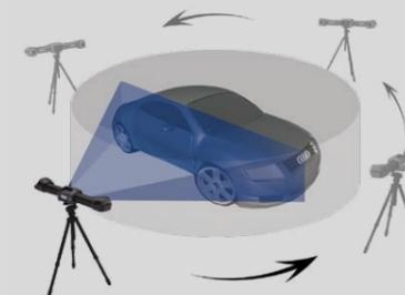
**Flexibles Messvolumen,** das einfach und dynamisch ohne Präzisionsverlust oder konventionelle Leapfrogs erweitert werden kann.
