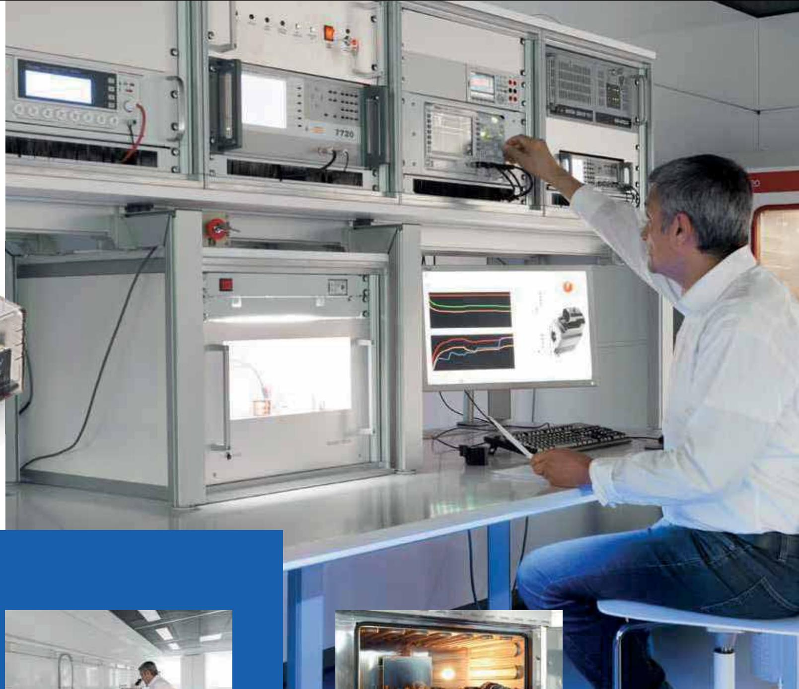
Das Prüflabor spielt eine unverzichtbare Rolle bei der Gewährleistung der maximalen Qualität in jeder Produktionsphase, indem es Tests zur Bestimmung von Widerstandswert, Wicklungsisolierung, Masseisolierung, Induktionswert, transients Verifikationsfähigkeit, Temperaturüberwachung, Restmagnetismus, Zugwert, Kraft-Weg-Diagramm und Ansprechzeit der Elektroventile sowie spektrographische Materialanalysen durchführt.
