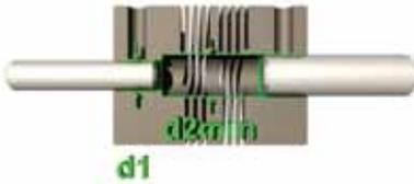
$d1 < d2 = d2min$ , die grosse Achse darf nicht unter die Helikale geraten, sehe „N“ Dimension von der Kupplung!
