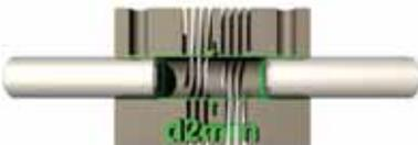
$d1 = d2 = d2min$ , Achse darf nicht unter die Helikale geraten, sehe „N“ Dimension von der Kupplung!
