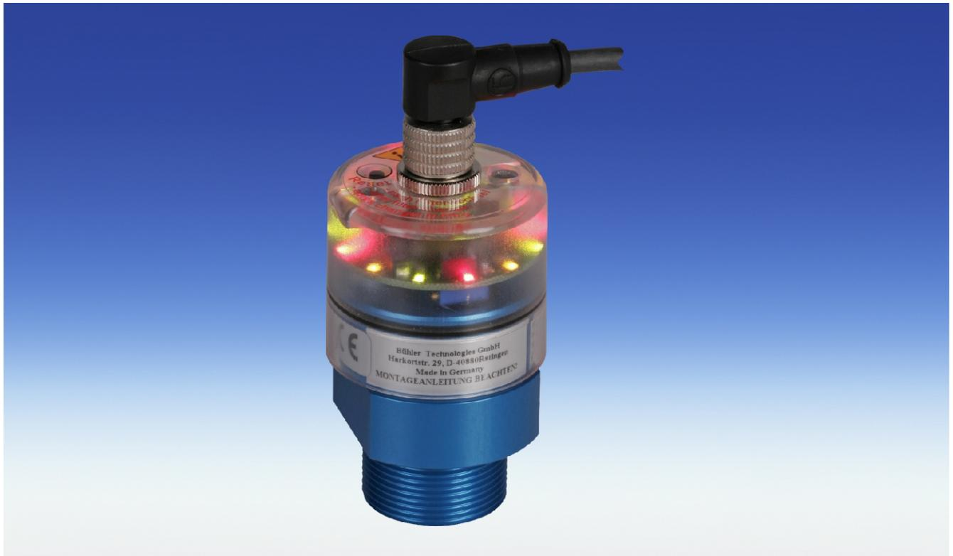
Der Verschmutzungsanzeiger VSA 24 ist ein mikroprozessor-gesteuerter Druckschalter mit zwei Schaltausgängen für Vorwarnung (Filterverschmutzung hoch!) und Abschaltung (Maximale Verschmutzung erreicht!).
