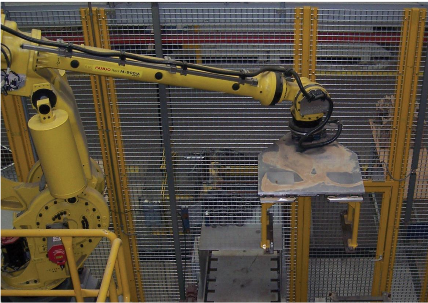
Handhabung von Sandkernen Handling of sand cores
