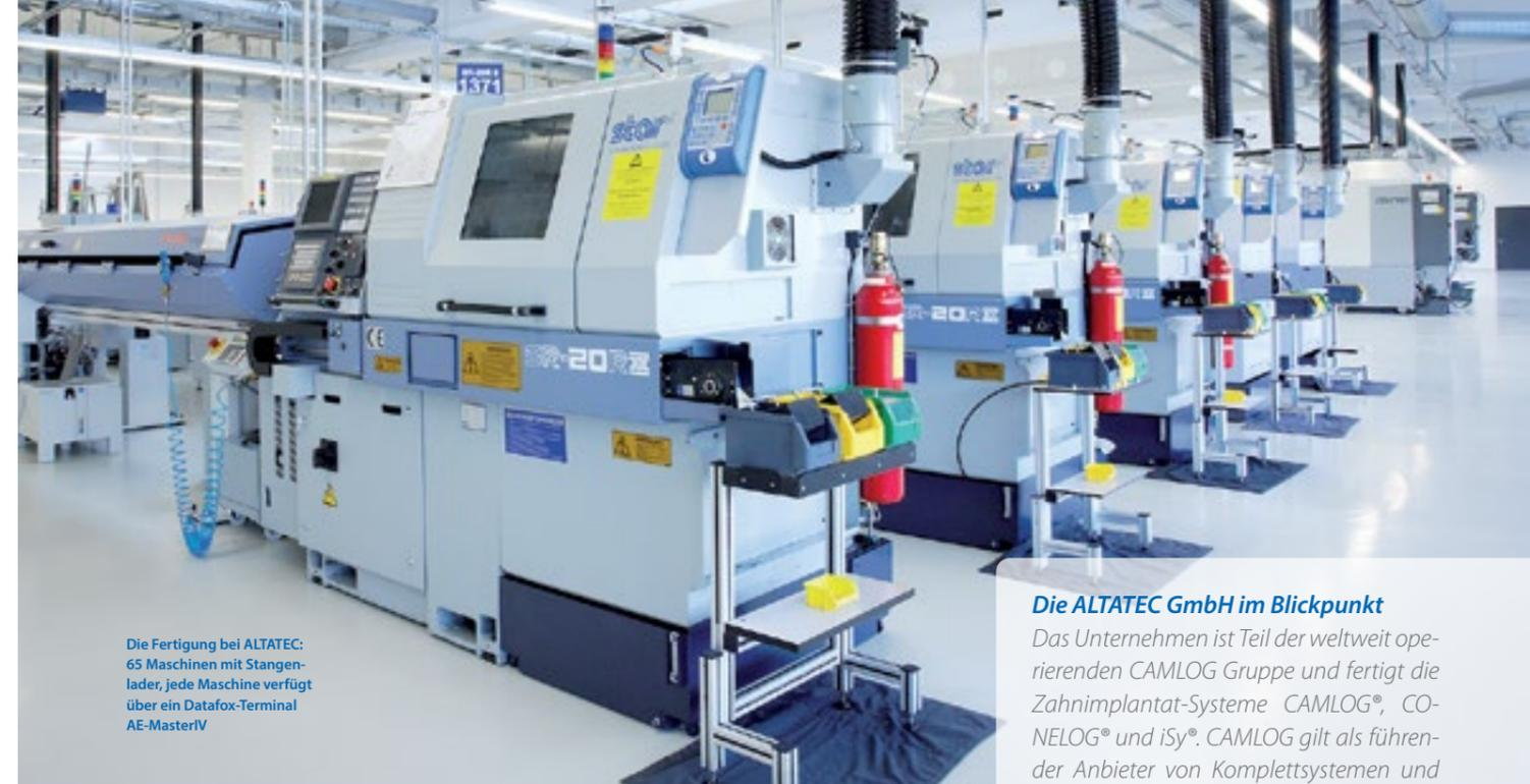
Die Fertigung bei ALTATEC: 65 Maschinen mit Stangenlader, jede Maschine verfügt über ein Datafox-Terminal AE-MasterIV
