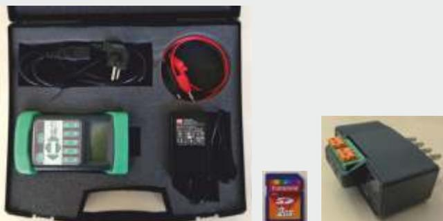
Im Lieferumfang ist eine Gummischutzkappe, eine SD-Speicherkarte, eine Terminal-Extension-Einheit sowie ein Koffer enthalten.
