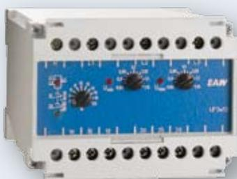
Das Relais überwacht den arithmetischen Mittelwert der gleichgerichteten Spannungshalbwellen zwischen den 3 Phasen eines Drehstromnetzes auf Über- und Unterschreitung der Einzelwerte. Die integrierte Zeitstufe gestattet die verzögerte Relaisausgabe. Der Anschluß erfolgt in Dreieckschaltung.
