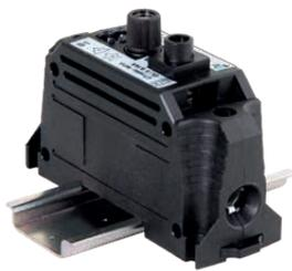
Platz sparende und einfach zu montierende Schienenklemme mit integriertem Stromwandler und gesichertem Spannungsabgriff
