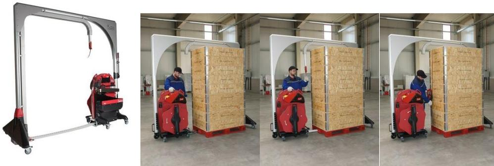
Dieser Zusatz macht das Umreifen von Paletten bis 3,0 m Höhe möglich. Er ist ebenfalls ideal geeignet, wenn es gilt, überstehendes Packgut oder Paletten mit empfindlicher Ware (etwa lackierte Oberflächen) sicher und schonend zu umreifen. Die Befestigung am ErgoPack erfolgt über einen lösbaren Schnellverschluss und kann in ca. 30 sec. gelöst werden, wenn Sie kleinere Paletten zu umreifen haben. Somit bleiben Sie maximal flexibel.
