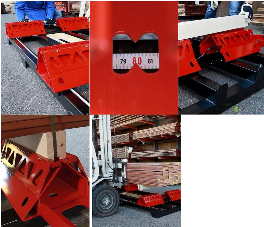
Mit der Schlittentunnel Mobilstation können Sie flexibel und präzise Unterleghölzer bei Ihrer Umreifung mit einbinden.
