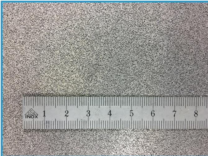
In Platten aus porösem Aluminium für Vakuumtische nehmen die Poren 50-55% der Oberfläche an jeder Stelle der Vakuumpalte und auf einer beliebigen kleinen Fläche ein.
