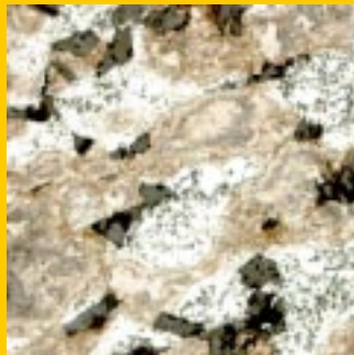
Mikrostruktur von bzw. ungeätzt und geätzt MMC. Schwarze Bereiche sind matrixverstärkten Partikeln mit erhöhter Verschleißbeständigkeit.
