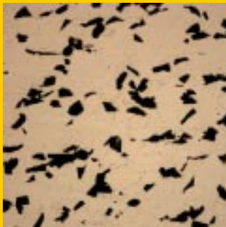
Mikrostruktur von bzw. ungeätzt und geätzt MMC. Schwarze Bereiche sind matrixverstärkten Partikeln mit erhöhter Verschleißbeständigkeit.
