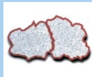
Metallpulverpartikel mit elektrisch isolierter Schicht und schematische Figur eines SMC-Materials.
