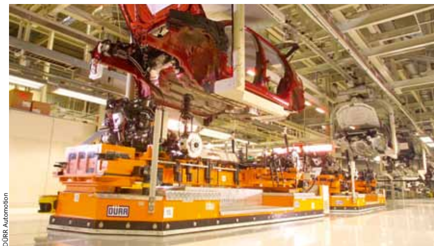
Oben links: Induktiv geführte FTF in der PKW-Montage
