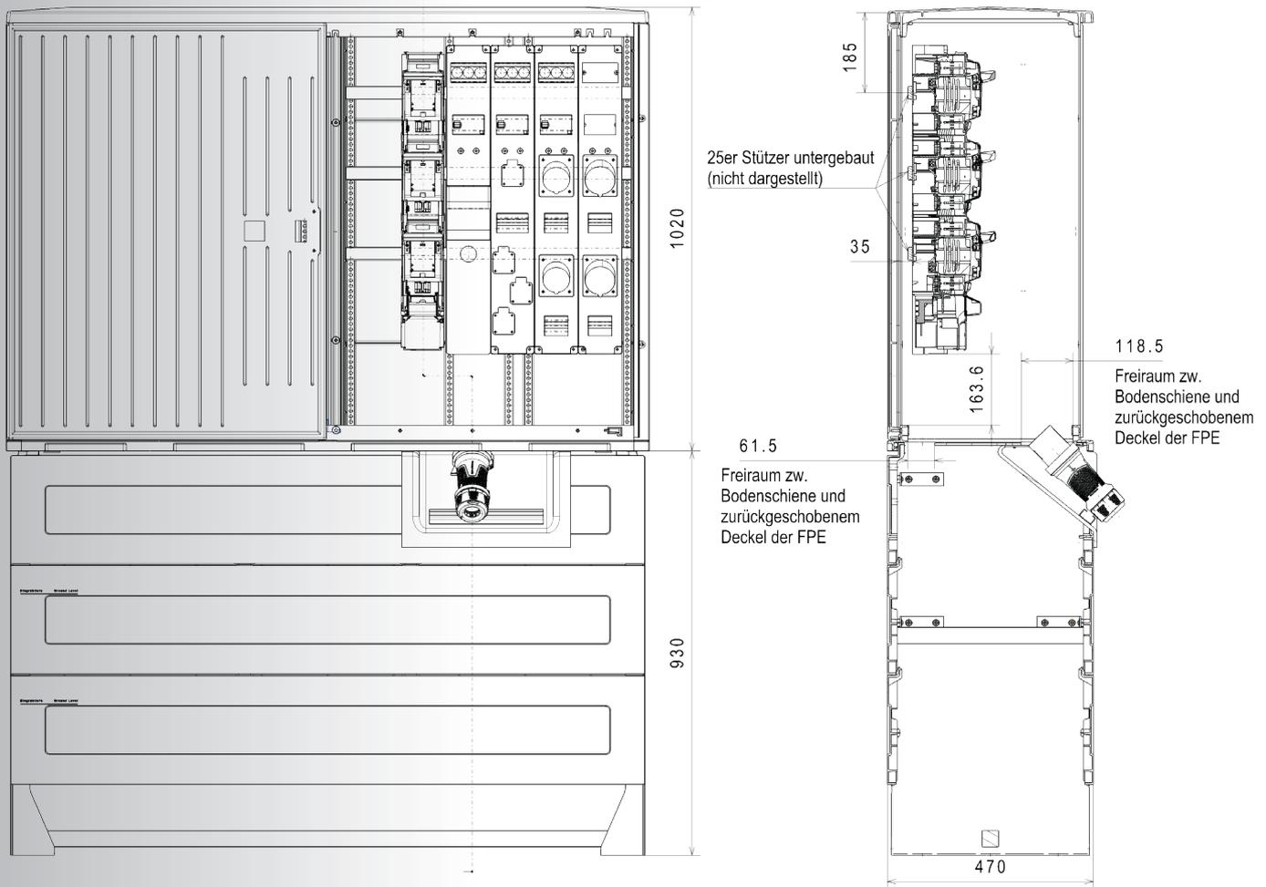
Einführung großer CEE-Stecker bis 63A ohne Demontage der Bodenschiene möglich.
