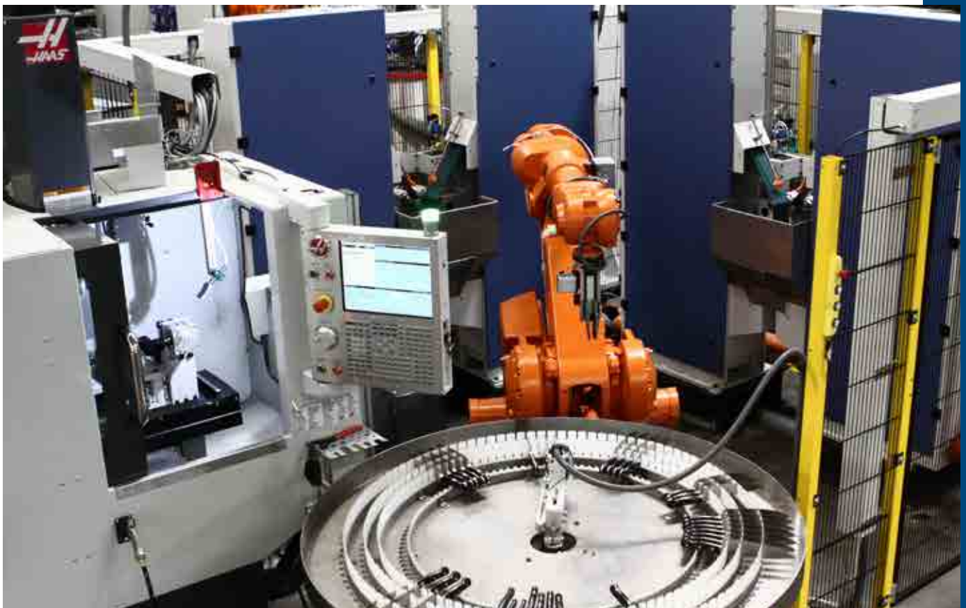
Roboter-Schleif- und -Frässtation RSP/5B/1F/2L zum Umfräsen und Planschleifen von Messergriffen und ähnlichen Werkstücken
