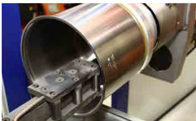
Beim Schleifen des Innenmantels hält der Roboter den Topf über Vakuumsystem.
