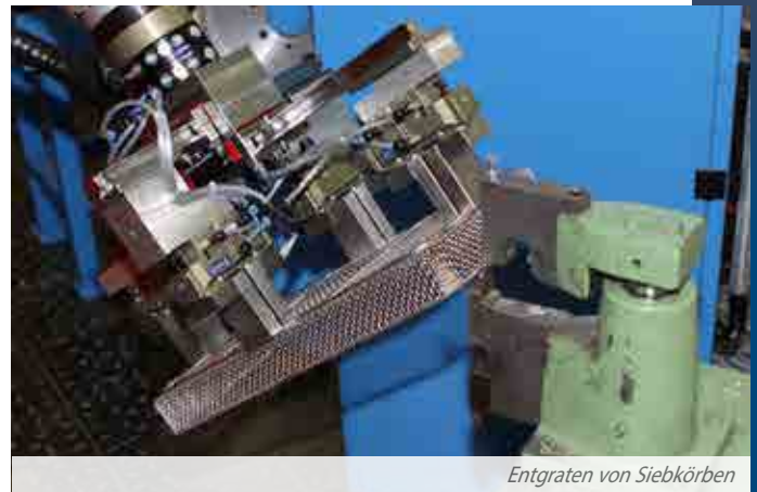
Roboterstation der Baureihe RSP/1L/1B/1P zur Bearbeitung von Siebkörben
