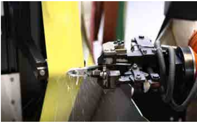
Schleifen von Zangen mit Roboterstation RSP/4B/1M
