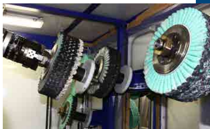
Vollautomatischer Wechsel der Polierscheiben
