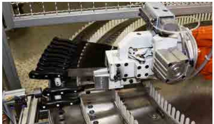
Indexierter Rundtisch mit verstellbaren Anschlägen zur Aufnahme von ca. 160 Werkstücken
