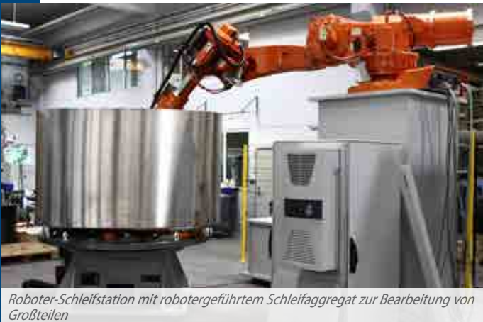
Roboter-Schleifstation mit robotergeführtem Schleifaggregat zur Innenbearbeitung von Hohlwaren
