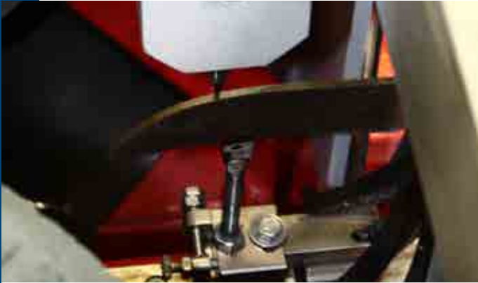
Messtaster zur Konturerfassung, in eine Konturschleifmaschine der Baureihe CG2-CNC integriert
