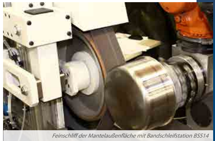
Schleifen der Mantelaußenfläche mit Bandschleifstation BSS14
