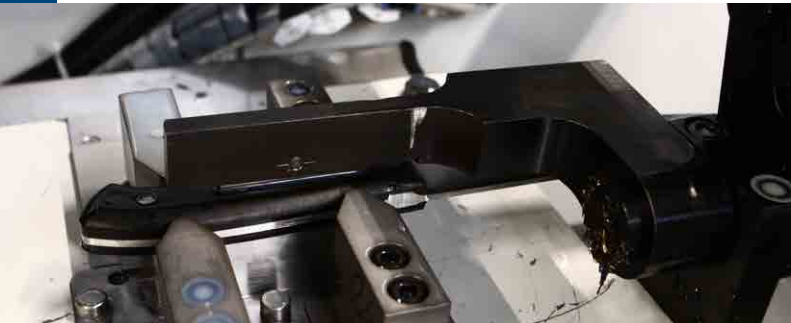
Roboter-Schleif- und Frässtation RSP/5B/1F/2L zum Planschleifen der Edelstahlrieten
