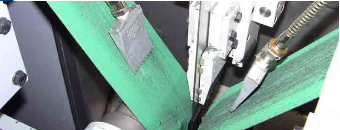
Roboter-Schleifstation zum Planschleifen von Messergriffen mit zwei gegenüber gestellten Bandschleifstationen des Typs BSS14
