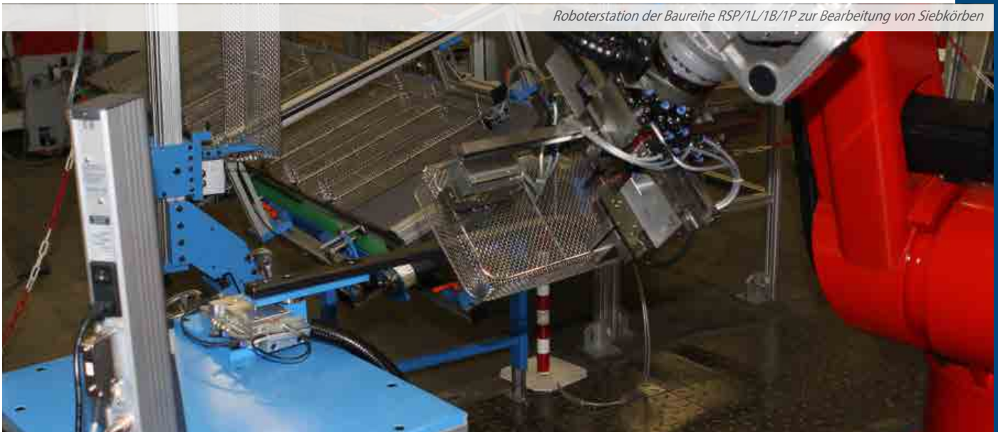
Entgraten von Siebkörben
