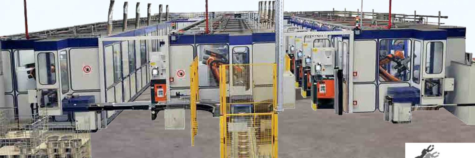
Roboter-Polieranlage mit 33 interagierenden Robotern
