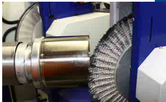
Roboter-Polieren des Topfrandes
