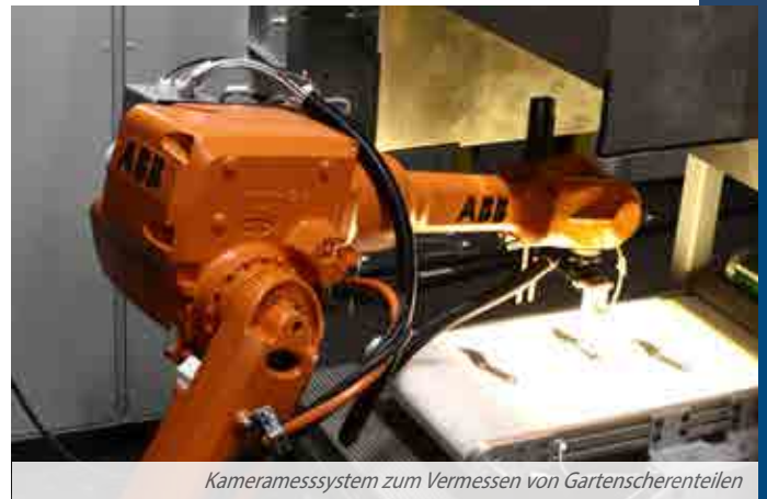
Kameramesssystem zum Vermessen von Zangen
