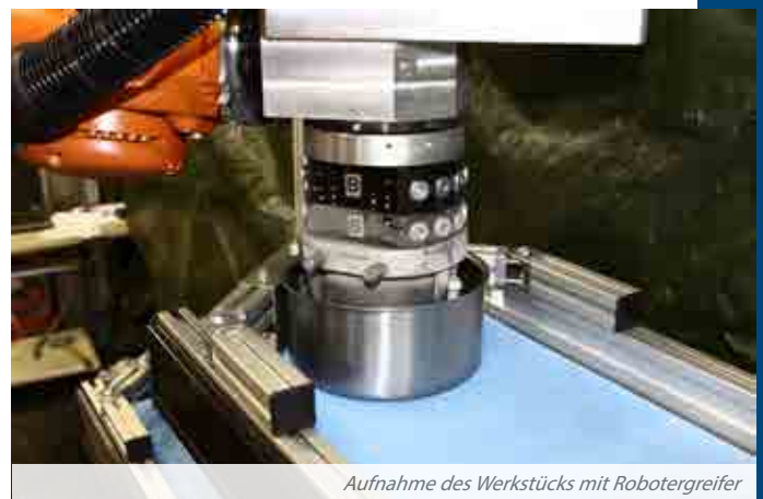
Polieren der Mantelaußenfläche mit Polierstation P5
