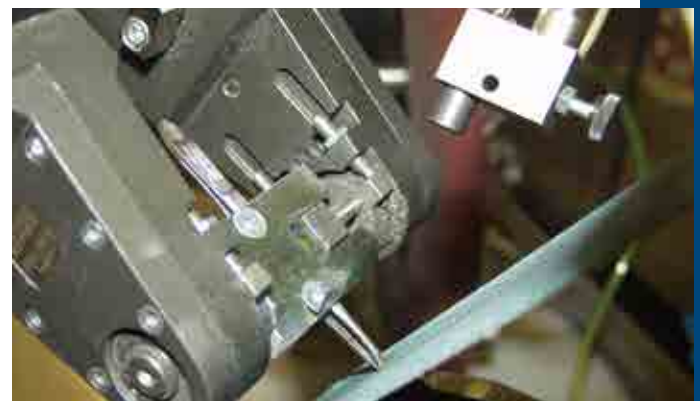
Roboter-Schleifstation RSP/2B/1S/1L zum Schleifen von Pinzetten mit zwei Bandschleifstationen, einem Spindelstock und einem Lasermesssystem
