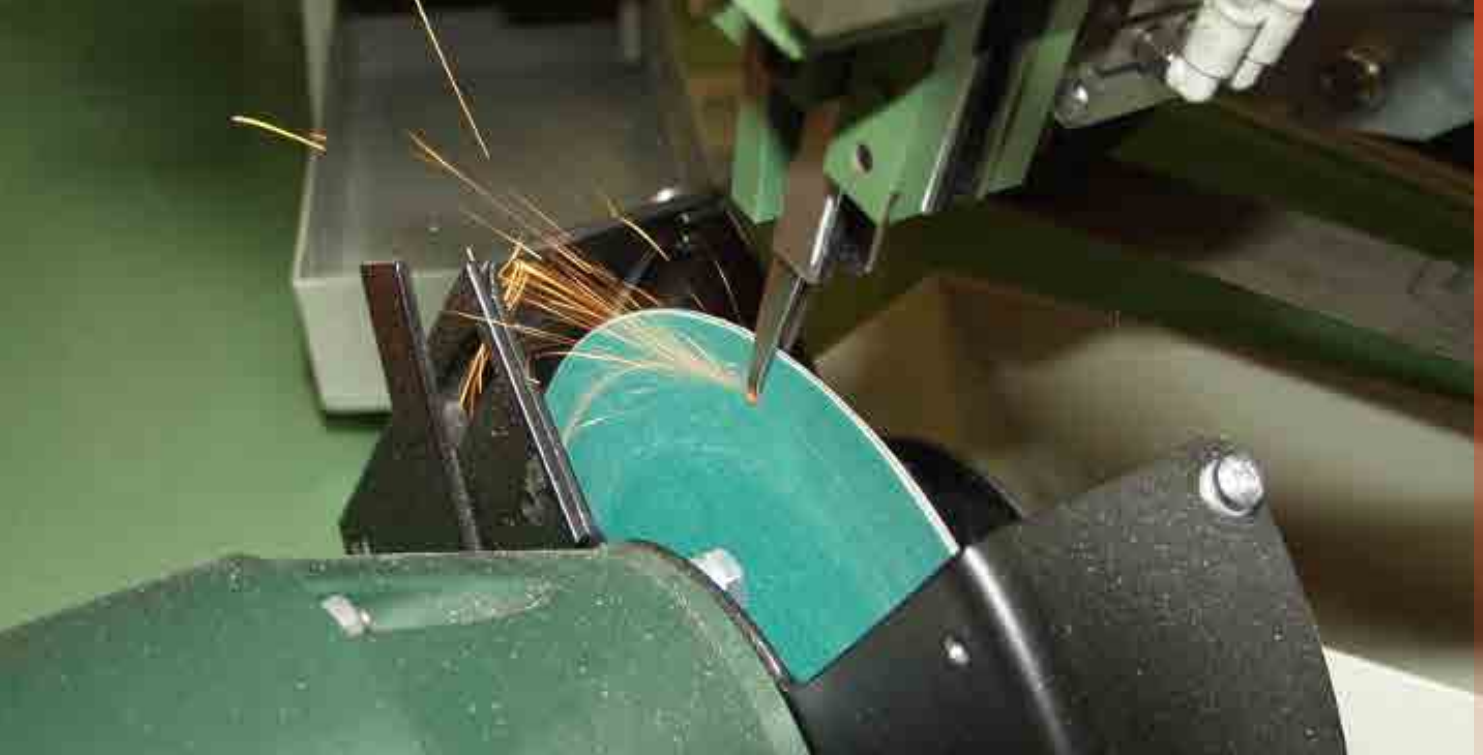
Schärfen von Manikürpinzetten
