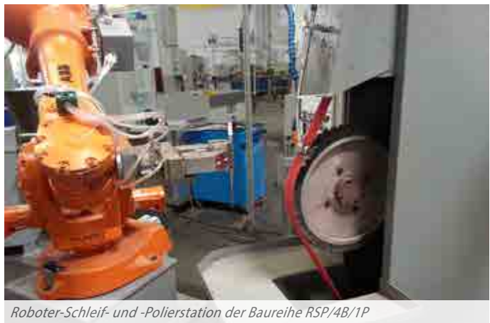
Umgreifstation für Rundumbearbeitung: Bearbeitung der Pinzettenfeder an Bandschleifstation
