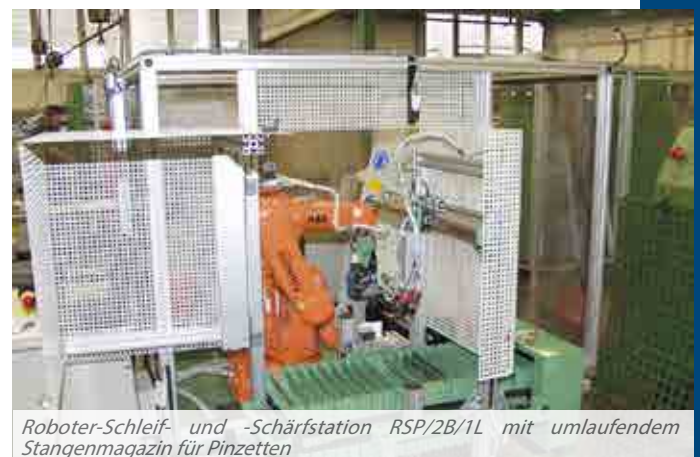
Roboter-Schleifstation RSP/2B/1S/1L zum Schleifen von Pinzetten mit zwei Bandschleifstationen, einem Spindelstock und einem Lasermesssystem
