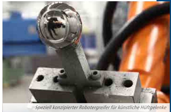
Roboterpolieren von künstlichen Hüftgelenken
