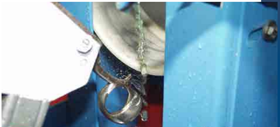
Schleifen der Außenkante mit hohem Materialabtrag
