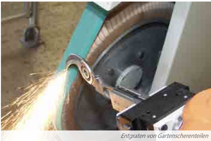
Schleifen von Zangen mit Roboterstation RSP/4B/1M
