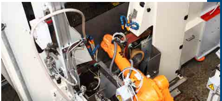
Rückenschliff an Scheren
