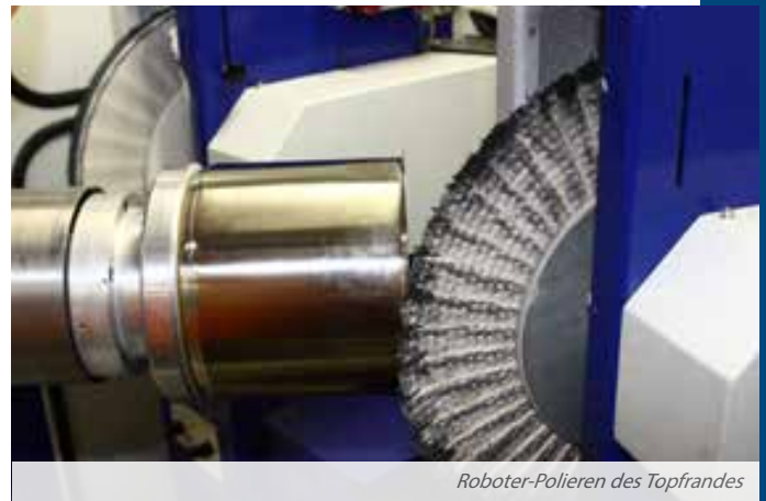
Roboter-Hochglanzpolieren des Außenmantels
