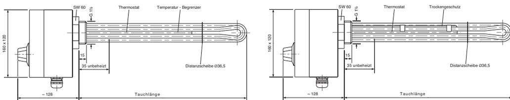
**Sonderanfertigung** Andere Längen, unbeheizte Zonen, Spannungen, Leistungen, Werkstoffe und Regelgeräte bitte anfragen!
