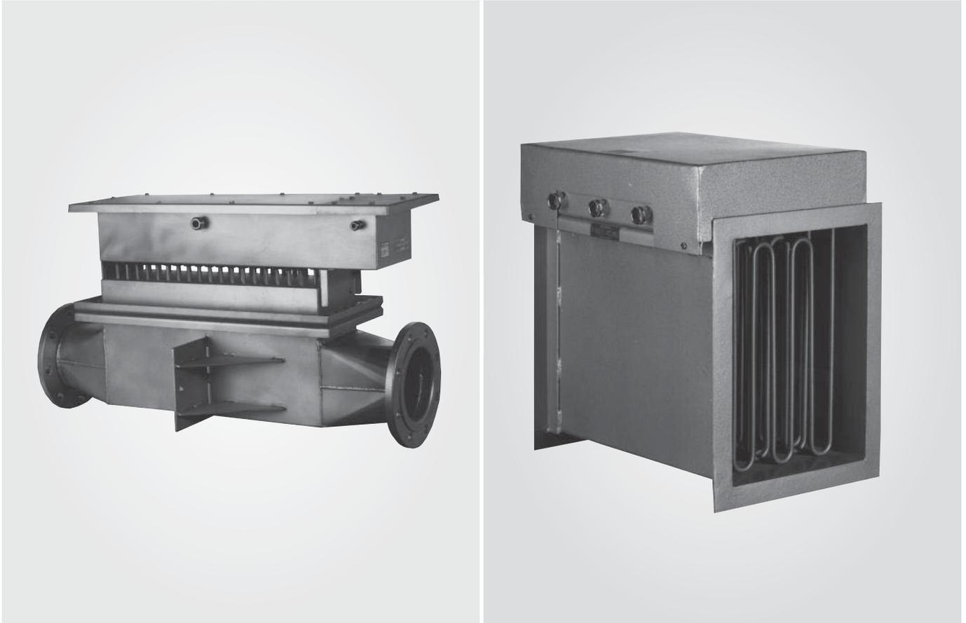
**Anwendung** HELIOS-Gaserhitzer dienen der Erwärmung von nicht-explosiven Gasen z. B. Luft, Wasserdampf, Stickstoff usw. auf max. 700 °C, bis zu 0,3 bar Überdruck. Heizlüfter befinden sich auf der Katalogseite 6.7.
