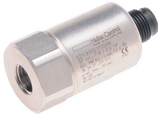
Die kompakten Druckschalter der Typenreihe 521 basieren auf der von Huba Control entwickelten Dickschicht-Technologie, bei der die Druckmesszelle dichtungsfrei mit dem Druckaufnehmer verschweisst ist.
