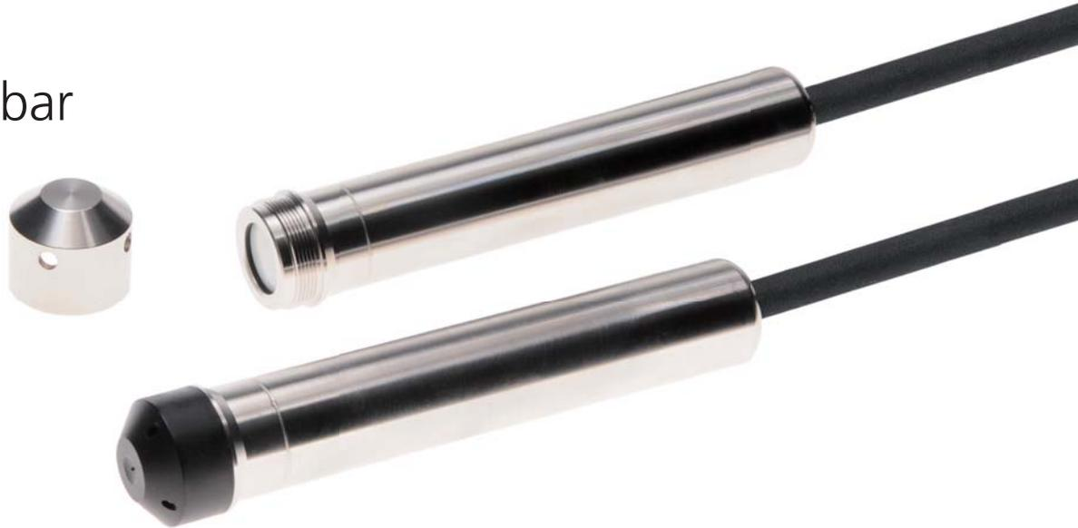
Die Tauchsonde 711 ist mit einer Relativdruckmesszelle ausgestattet und wandelt den hydrostatischen Füllstandsdruck in ein 4 ... 20 mA Ausgangssignal um. Zusätzlich sind Kabellängen von 3 bis 300 Meter verfügbar. Ebenso sind Varianten mit Explosionsschutz sowie mit Trinkwasserzulassungen erhältlich.
