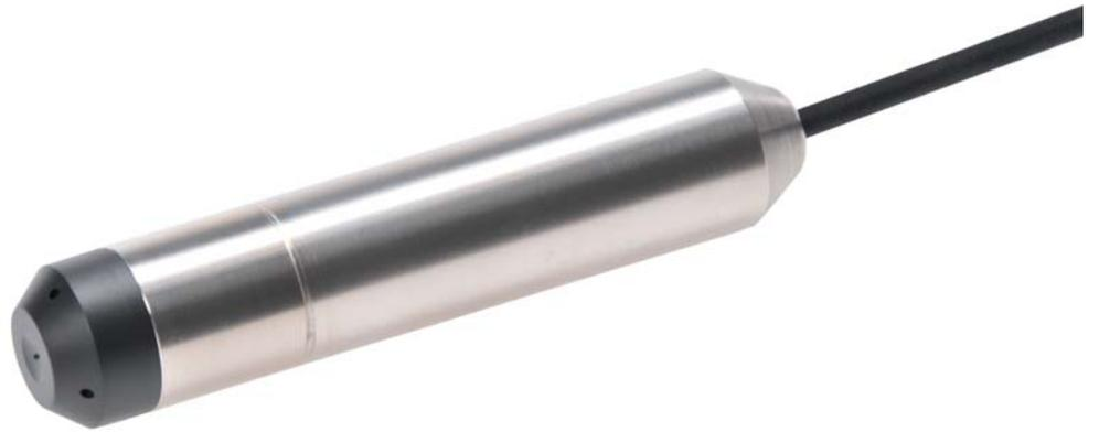
Die Tauchsonden Typ 712 sind mit einer Relativ- oder Absolutdruckmesszelle ausgestattet. Die Typenreihe 712 ist mit abgeglichenem und verstärktem Sensorsignal erhältlich. Zusätzlich sind Kabel-längen von 2 bis 30 Meter verfügbar. Ebenso ist eine Variante mit Explosionsschutz sowie eine Variante mit integrierter Temperaturmessung erhältlich.
