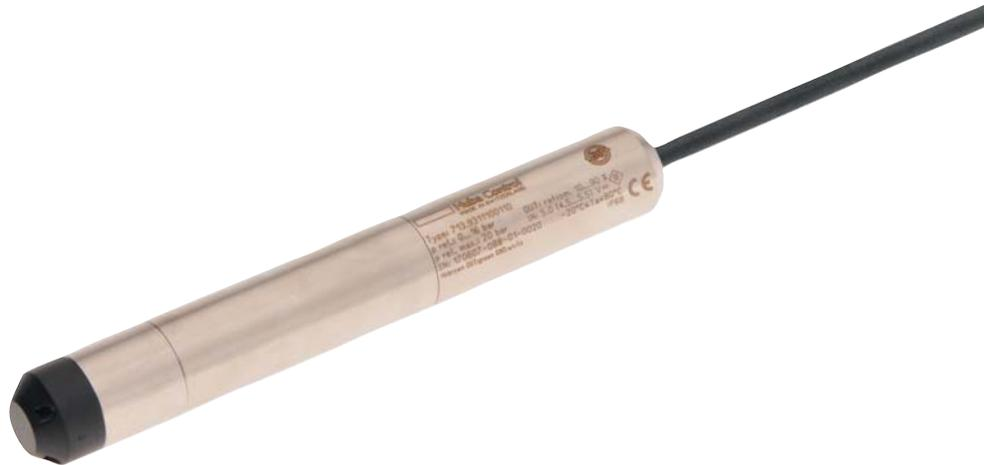
Die Tauchsonde Typ 713 wird zur kontinuierlichen Füllstands- und Pegelmessungen von Grund- und Trinkwasser eingesetzt. Aufgrund ihrer kompakten Bauweise eignet sich diese Pegelsonde hervorragend für den Einsatz in beengten Einbauräumen. Der schlanke Durchmesser von 18.5 Millimeter ermöglicht den Einbau in  $\frac{3}{4}$ -Zoll Rohre.
