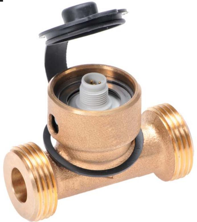
Die Durchflusssensoren vom Typ 230 basieren auf dem Prinzip der Kármánschen Wirbelstrasse. Wahlweise stehen Varianten mit integrierter Temperaturmessung zur Verfügung.
