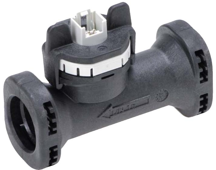
Die Durchflusssensoren der Typenreihe 200 basieren auf dem Prinzip der Kármánschen Wirbelstrasse. Wahlweise stehen Varianten mit integrierter Temperaturmessung zur Verfügung. Diese Durchflusssensoren ohne bewegte Teile sind unempfindlich gegen Verschmutzung, zeichnen sich durch einen geringen Druckverlust und sehr gute Genauigkeit aus.
