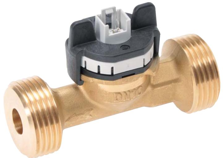
Der Durchflusssensor Typ 235 unterscheidet sich zum Durchflusssensor Typ 200 in der Messing-Gehäuseausführung. Die Durchflusssensoren der Typenreihe 235 basieren auf dem Prinzip der Kármánschen Wirbelstrasse. Wahlweise stehen Varianten mit integrierter Temperaturmessung zur Verfügung. Diese Durchflusssensoren ohne bewegte Teile sind unempfindlich gegen Verschmutzung, zeichnen sich durch einen geringen Druckverlust und sehr guter Genauigkeit aus.
