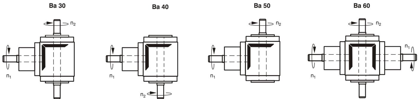
INKOMA-Kegelradgetriebe KL können durch ihre Bauweise mit anderen Produkten kombiniert werden.
