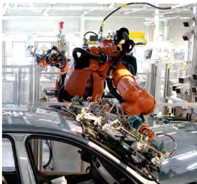
Zur Prüfung der Maßhaltigkeit stellt ISRA einen intelligenten Werkzeugkasten aus der 3D Inline-Messtechnik zur Verfügung.
