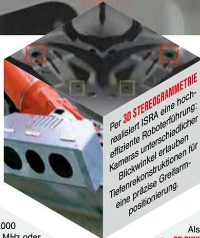
Per **3D STEREOGRAMMETRIE** realisiert ISRA eine hoch-effiziente Roboterführung: Kameras unterschiedlicher Blickwinkel erlauben Tiefenrekonstruktionen für eine präzise Greifarm-positionierung.
