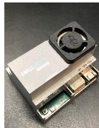
Mit dem smelldect-Demonstrator können olfaktorische Informationen schnell und einfach erfasst werden. (Foto: Martin Sommer, KIT)
