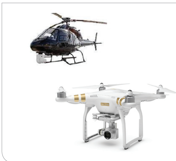
Helikopter mit 3D-Laserscanner und Drohne mit Kamera
