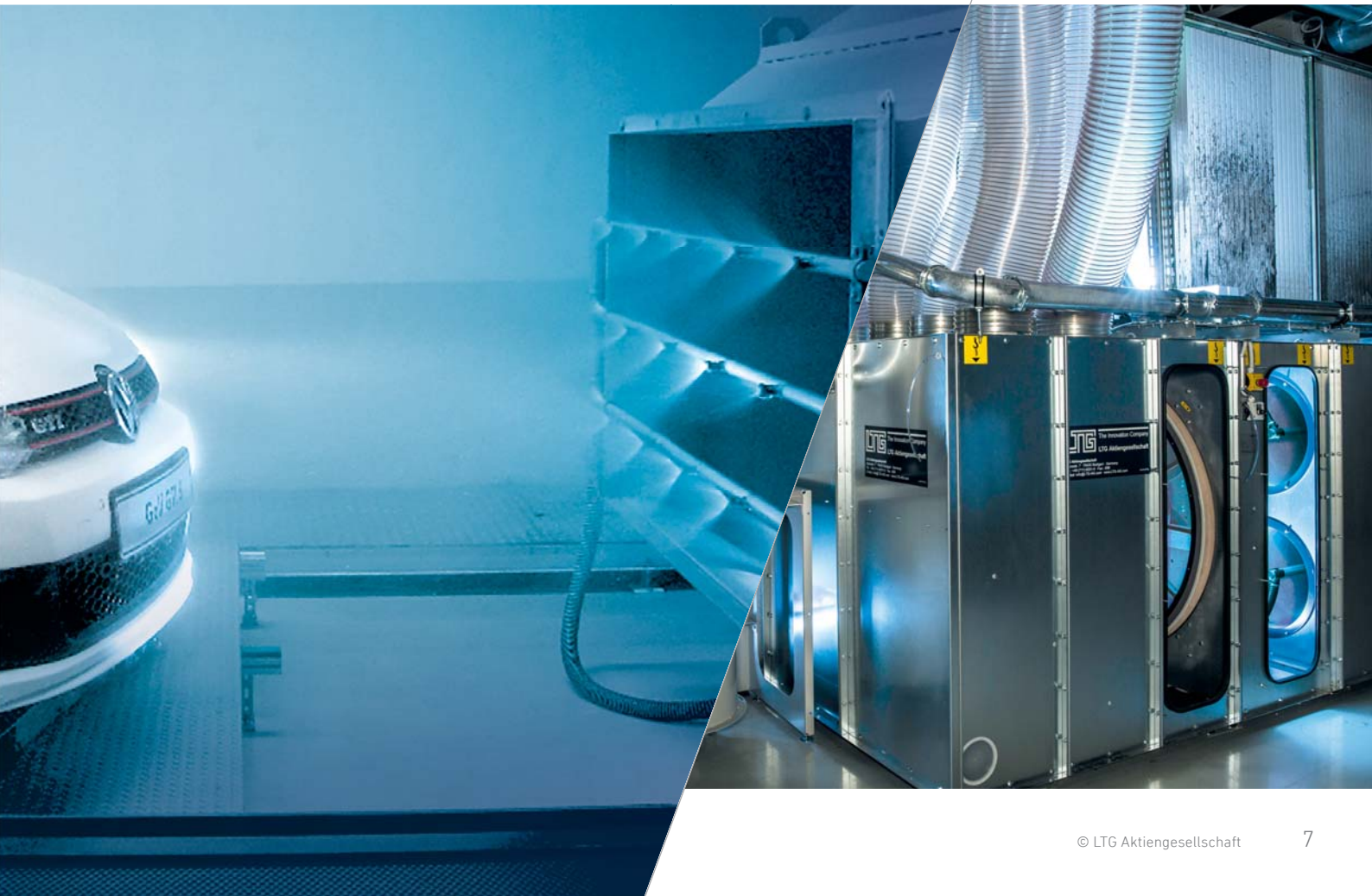
Optimierung der Luftführung in einem Prüfstand mit Regensimulation
