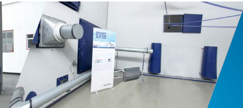
Messungen des Schalleistungspegels im Hallraum
