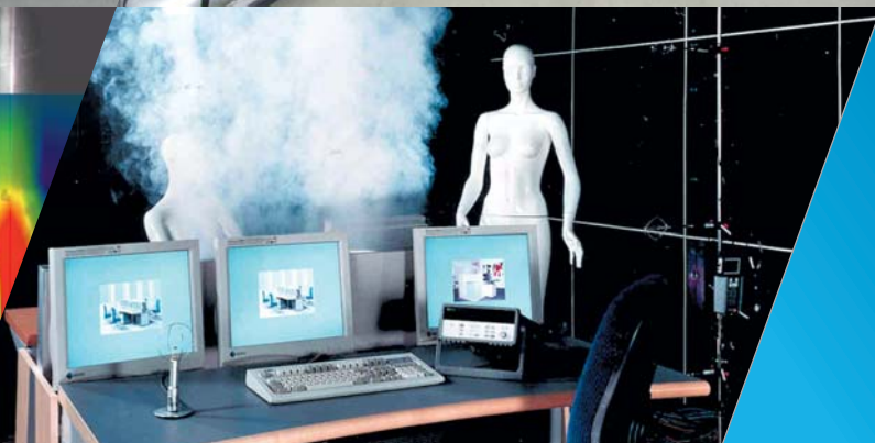
Experimentelle Optimierung der Klimatisierung von Händler-tischen
