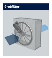
Der mit groben Partikeln beladene Luftstrom durchströmt ein Filtermedium, dessen Maschenweite den Partikeln angepasst wird. Die Abreinigung des Filtermediums erfolgt kontinuierlich durch Absaugung.
