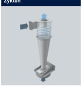
Der mit Partikeln beladene Luftstrom tritt am Zyklon (Fliehkraftabscheider) tangential ein. Der Feststoff wird durch die rotierende Luftströmung zentrifugal nach außen getragen und gleitet spiralförmig in einen Auffangbehälter oder in den darunter montierten Staubkompaktor.
