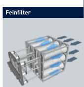
Die staubige Luft strömt von innen durch die Filtertrommeln, der Staub setzt sich an der Innenseite ab und wird kontinuierlich von rotierenden Absaugdüsen abgereinigt. Durch die kontinuierliche Abreinigung wird ein konstanter Druckverlauf im System erreicht. Alle Antriebselemente befinden sich auf der sauberen Seite und sind damit vor Verschmutzungen geschützt.
