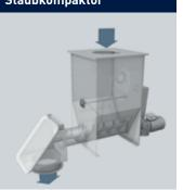
Das zuvor abgeschiedene Material wird von einer horizontalen Stopfschnecke erfasst und ausgetragen. Ein Rührwerk sichert die gleichmäßige Beschickung der Schnecke und verhindert die Bildung von Feststoffbrücken. Die Materialverdichtung erfolgt durch eine Federlamellenmembran.
