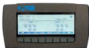
Halbgrafisches Benutzerterminal mit Multifunktionstasten und dynamischen Anzeigesymbolen.
