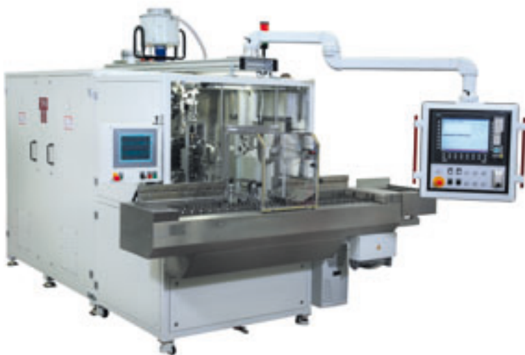
Montage- und Funktionsprüfanlage
