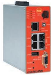
Neben den Industrie-Routern mbNET mit Edge Computing ist auch das Edge Gateway mbXLINK als Datendiode (ohne Fernwartung) verfügbar. Die Datendiode ermöglicht es, Kommunikation vom Netzwerk zum Feldbus per Schlüssel-schalter auf der physikalischen Ebene zu sperren. mbXLINK bietet die Funktionalität der Datendiode in Verbindung mit allen mbEDGE Funktionalitäten, um Maschinendaten sicher zu erfassen, zu verarbeiten und an Ihre Cloud-Anwendung weiterzuleiten.
