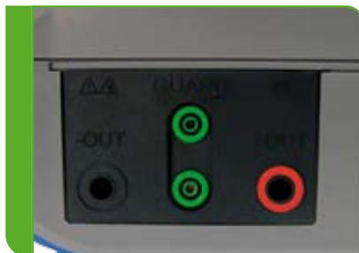
Das Anschlussfeld zum anschliessen der geschirmten Prüfleitungen.
