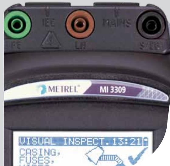
Der neue **MI 3309 DeltaGT** ist ein **batteriebetriebenes** sowie **Netzbetriebenes** Multifunktionsgerät zum Prüfen der elektrischen Sicherheit von ortsveränderlichen elektrischen Geräten. Dank des großen grafischen LCD-Displays mit Hintergrundbeleuchtung, zwei GUT / SCHLECHT-LED-Anzeigen sowie einem Stromlaufplan mit Anschlussschema (Hilfemenü) für jede Messung, ist die Bedienung des Instruments klar und einfach.
