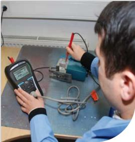
Der neue MI 3311 GammaGT ist ein netzunabhängiges Multifunktionsgerät zum Prüfen der elektrischen Sicherheit von ortsveränderlichen elektrischen Geräten. Dank des großen grafischen LCD-Displays mit Hintergrundbeleuchtung, zwei GUT / SCHLECHT-LED-Anzeigen sowie einem Stromlaufplan mit Anschlußschema für jede Messung, ist die Bedienung des Instruments klar
