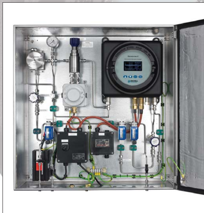
Condumax II Probenahme-System (Außenmontage)
