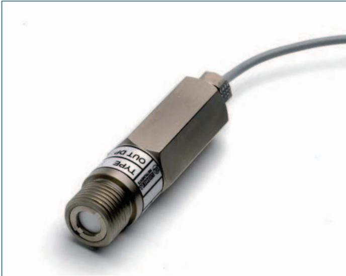
Der SF52 Taupunkt Transmitter wurde für den Einsatz in Druckluftsystemen zur Überwachung des Drucktaupunkts oder der Absolutfeuchte bei Drücken bis 20 bar entwickelt. Durch den G1/2" Gewindeanschluss und die integrierte HDPE Filterscheibe, hinter der der eigentliche Sensor geschützt betrieben wird, kann er ohne Probleme in einem Standard-Rohrstutzen direkt eingeschraubt werden.
