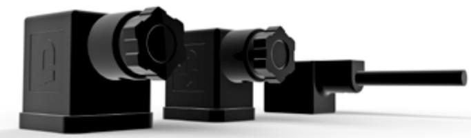
Leitungsdosen „mit angespritztem Kabel“ mit den Standard-Kabel-längen 2 und 5 Meter. Das Standardmaterial der Kabelummantelung ist PVC, PUR ist auf Anfrage möglich. Diese speziellen Kabelbuchsen sparen Zeit bei der Verkabelung, da das Kabel bereits angeschlossen und mit ummantelt wird, was ihre IP67 Zertifizierung begründet. Das Ummantelungsmaterial des Steckerkopfes ist Beständig gegen Öl und auf Wunsch auch gegen UV.
