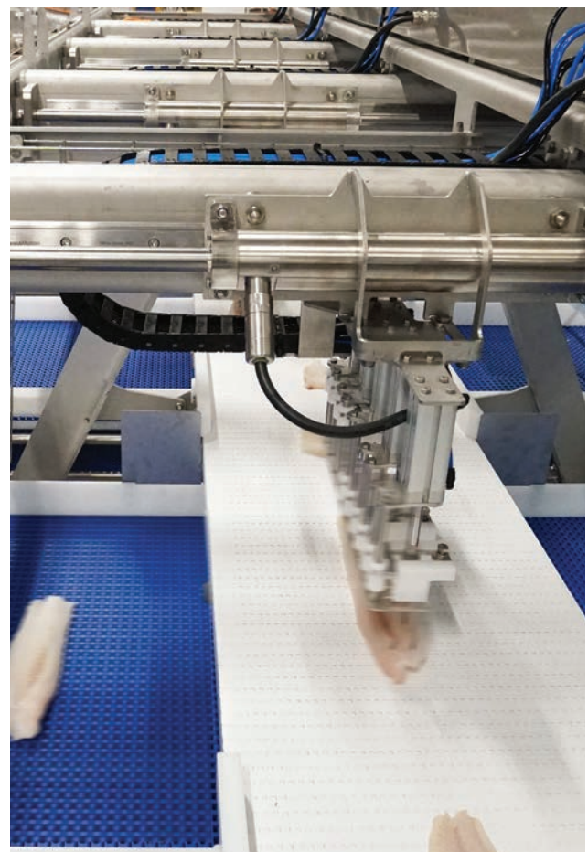
Realisierung des Portionssortierers mit einem LinMot Edelstahl Motor
