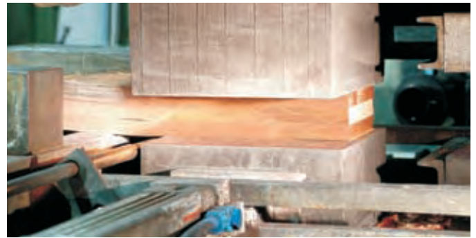
Bilder rechts: Pressschweißen
