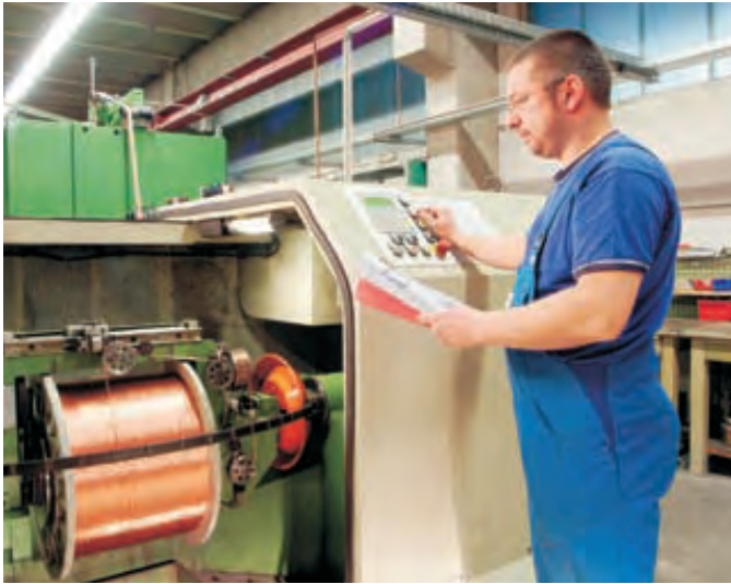
Verlitzen und Verseilen hochflexibler Leiter
