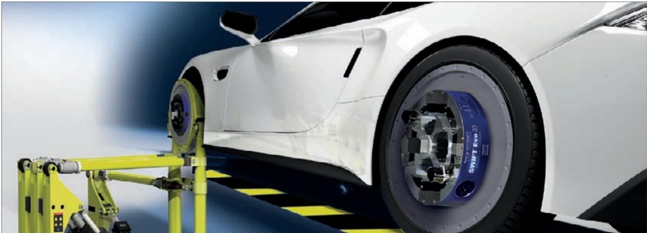
**SWIFT® Evo** ist das erste Gemeinschaftsprodukt der Unternehmen MTS Systems und PCB Piezotronics, Inc. und stellt die neueste Messradgeneration dar (**Spinning Wheel Integrated Force Transducer**, kurz SWIFT®). Das innovative einteilige Messradsystem kam seit seiner Einführung weltweit in zahlreichen Entwicklungsprogrammen diverser Fahrzeughersteller und Zulieferer zum Einsatz.
