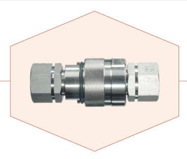
Schnellverschluss-Schraubkupplungen sperren beidseitig ab. Die Verbindung von Kupplungsmuffe und Kupplungsstecker erfolgt durch Verschraubung mit der Handmutter. Beim Kupplungsvorgang ist der Ventilraum bereits abgedichtet bevor die Ventile sich öffnen. Beim Entkuppeln noch geschlossen bevor die Verbindung getrennt werden kann. Das Kuppeln unter Druck stehender Kupplungshälften ist zu vermeiden, da sonst die Ventileinheiten beschädigt werden.
