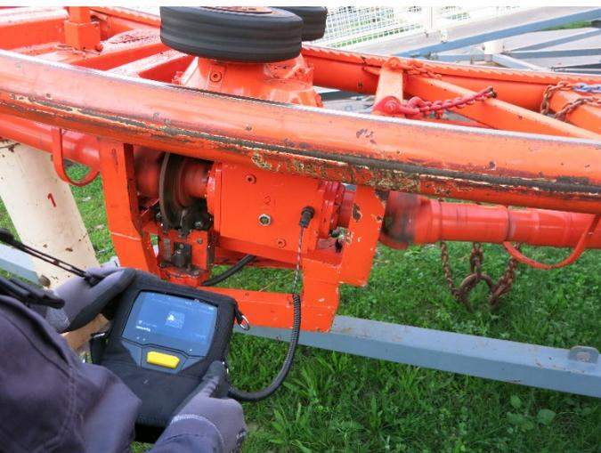
*In nur wenigen Sekunden kann der neue VIBSCANNER® 2 alle Messdaten aufnehmen. Insgesamt müssen hier 76 Messpunkte aufgenommen werden in bis zu 54 m Höhe über dem Boden.*
