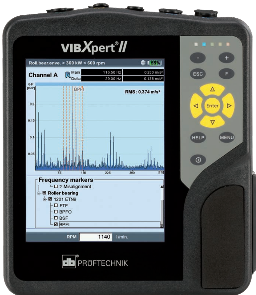
Hüllkurvenspektrum eines Wälzlager-Innenringschadens (BPFI) mit Kennzeichnung der Seitenbänder.
