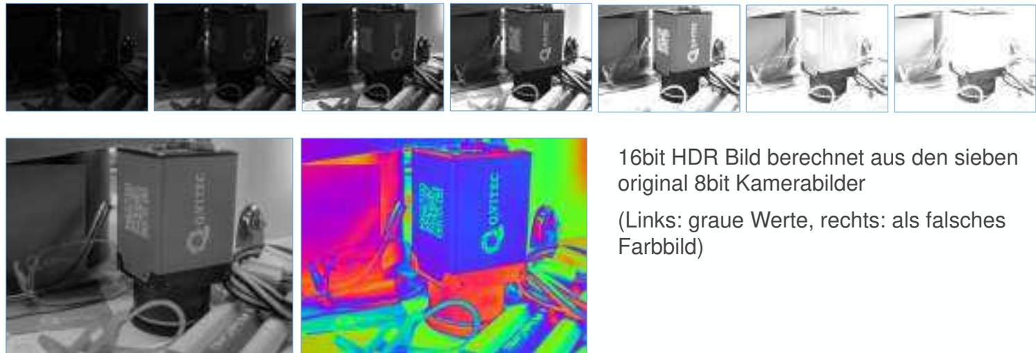
16bit HDR Bild berechnet aus den sieben original 8bit Kamerabilder
