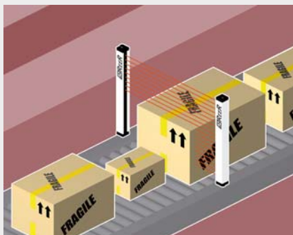
Messen der Höhe von Objekten auf Transportsystemen
