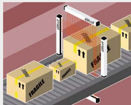
Zweidimensionales Vermessen von Objekten auf Transportsystemen durch Einsatz von 2 Lichtvorhängen
