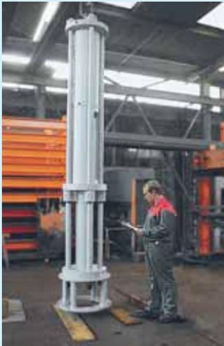
Druckübersetzer für Hydroforming
