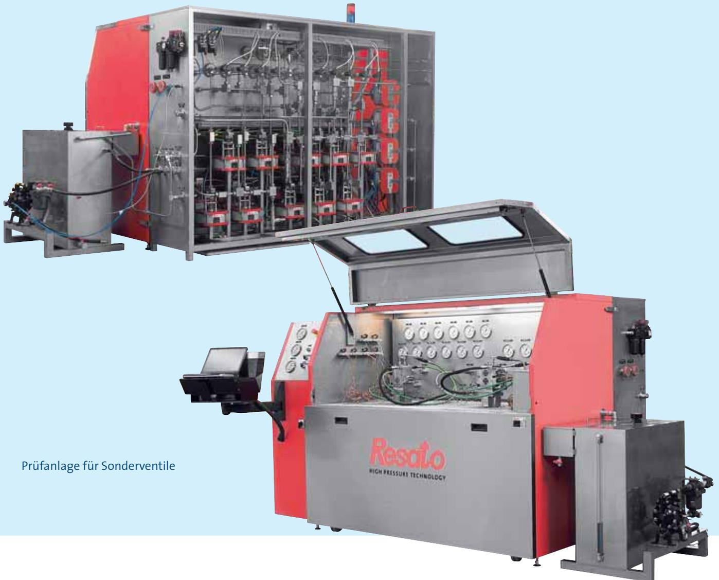
Prüfanlage für Sonderventile
